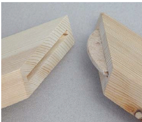
De lamello is in het groefje gelijmd
