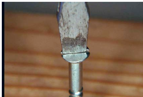
Indraaien van een houtschroef
