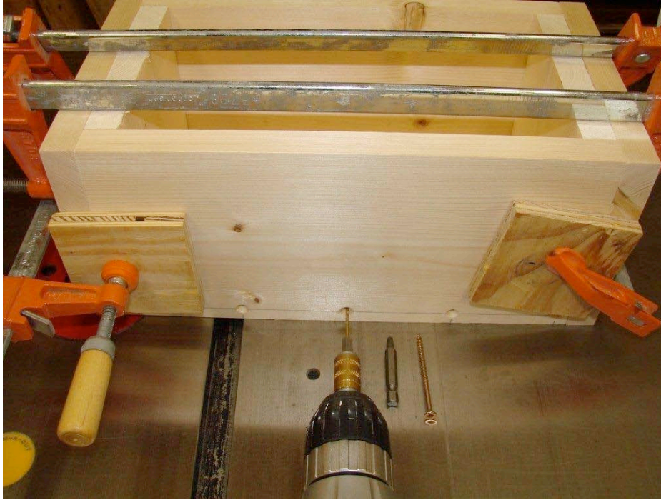
Houten klosjes tussen de lijmklem en het werkstuk
